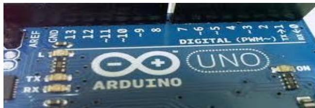
**Figura 3** – Portas *PWMs* na Placa Arduino Uno.
